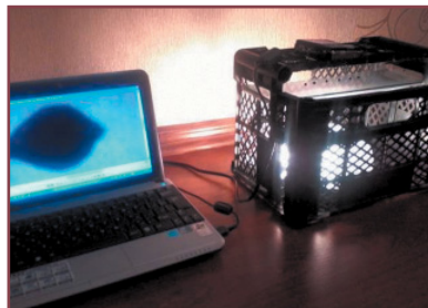
Фото 3, рис. 2. Загальний вигляд та схема лабораторної установки для визначення розмірних характеристик насіння гречки: 1 – корпус; 2 – полиця з об'єктами дослідження; 3 – місця кріплення фотообладнання; 4 – засоби фотознімання; 5 – лампа підсвічування; 6 – комп'ютер
